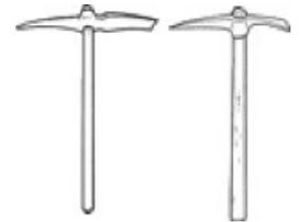
È costituito da una parte di metallo robusto (acciaio) leggermente ricurvo, terminante con due punte o con un'estremità a punta e l'altra a taglio, fissata ad un robusto manico in legno (quercia, ciliegio, bosso o gaggia).
