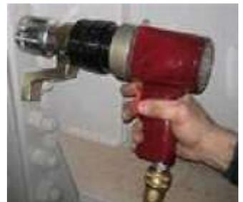
Altra caratteristica che distingue un avvitatore è la possibilità di invertire il senso di rotazione del mandrino per permettere di avvitare e svitare. I modelli più completi sono dotati di un meccanismo a frizione che permette di regolare la forza (o la coppia, per l'esattezza) con cui viene avvitata la vite.
