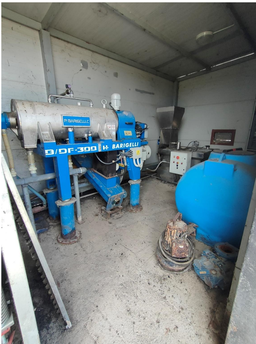
Figura 46: 5 – Decanter centrifugo dismesso
