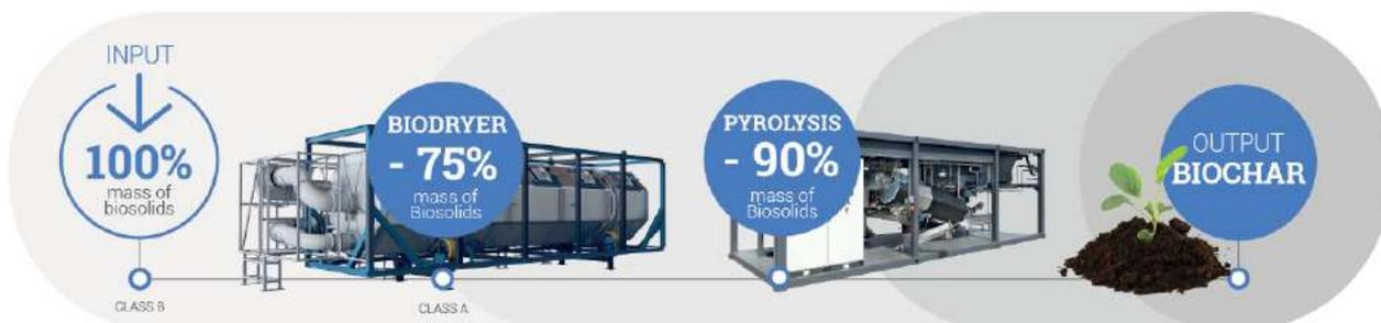
Figura 7: Schema del processo di bioessiccamento
