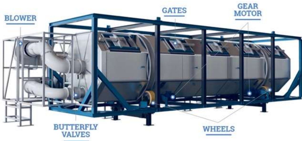
Figura 8: Rappresentazione 3D di un modulo BioDryer™
