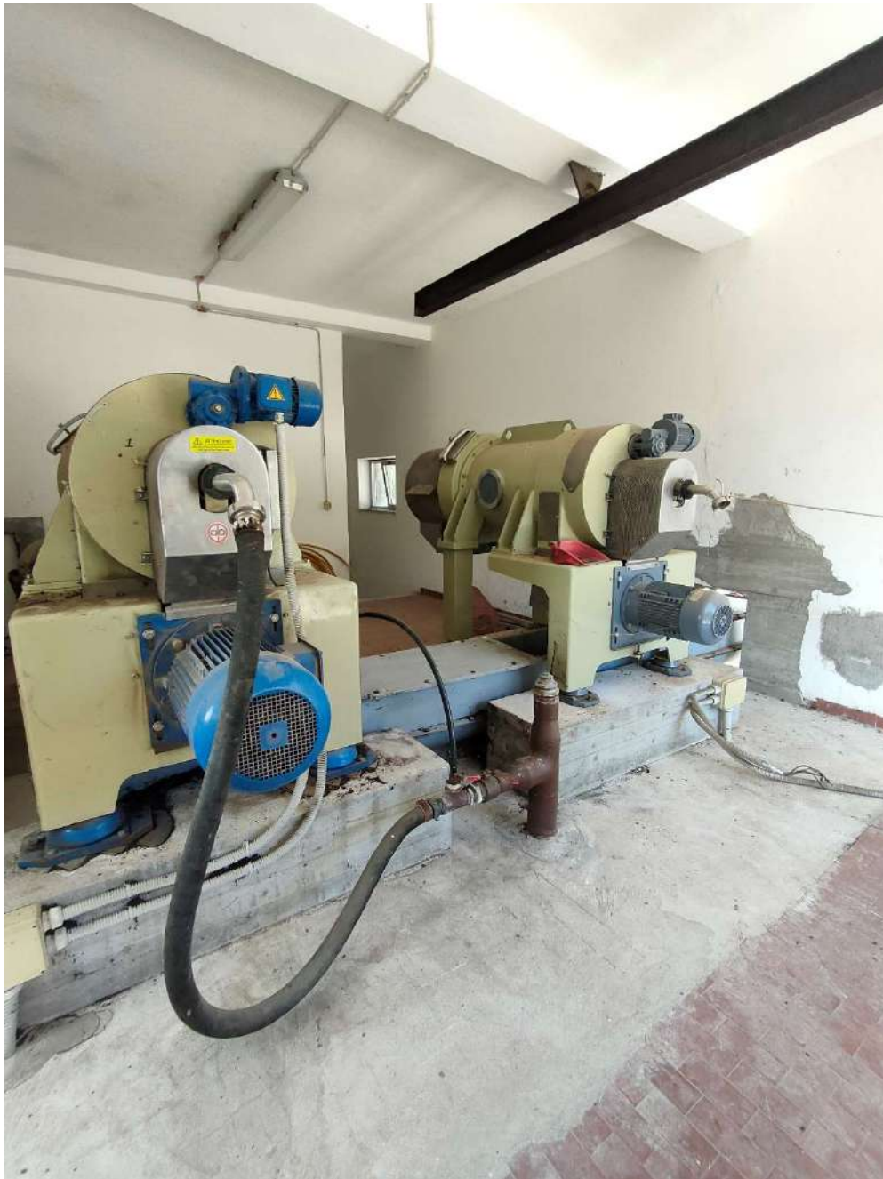
Figura 51: 2 – Primo piano - Centrifughe (una funzionante e una scollegata)
