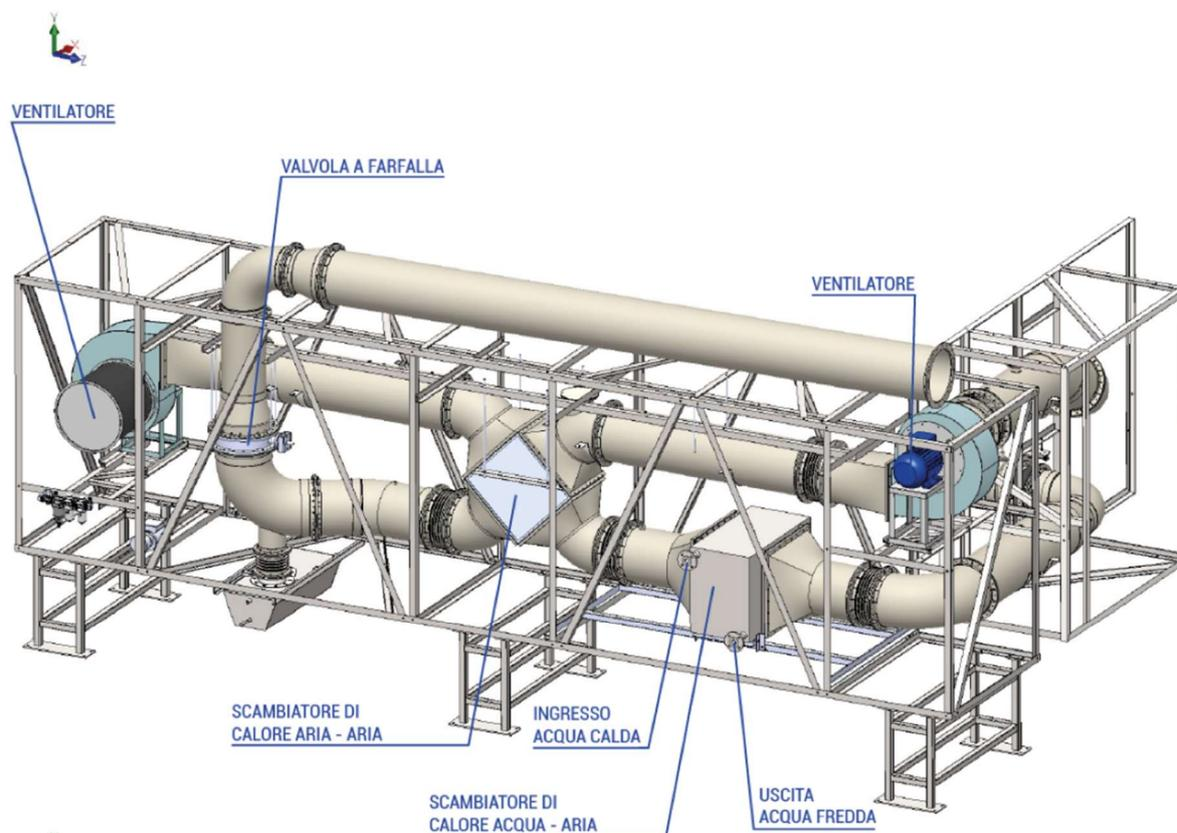
Figura 6: Rappresentazione 3D di un modulo BioDryer™, relativamente alla parte scambiatore di calore
