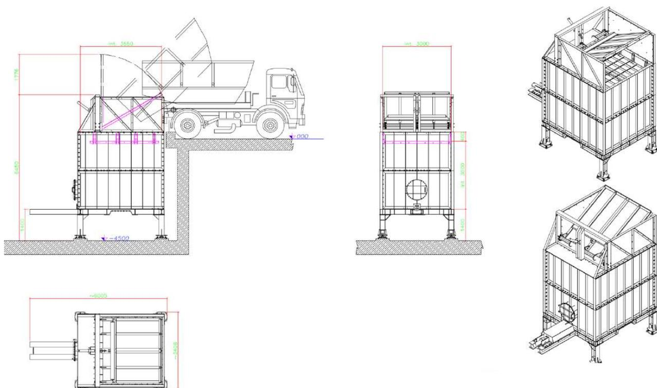
Figura 13: Disegno del sistema bunker di scarico e stoccaggio fanghi disidratati
