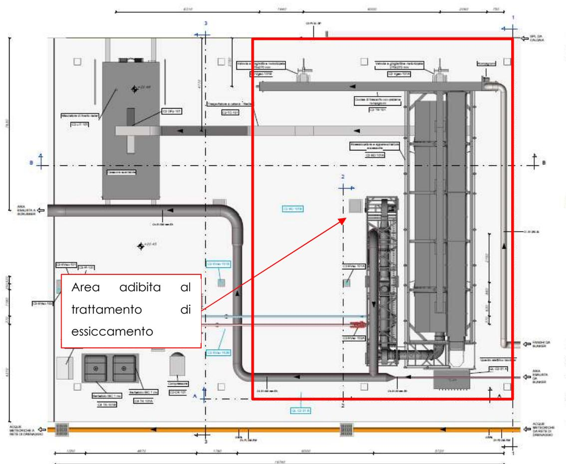
Figura 7: Vista planimetrica dell'area adibita al trattamento di essiccamento
