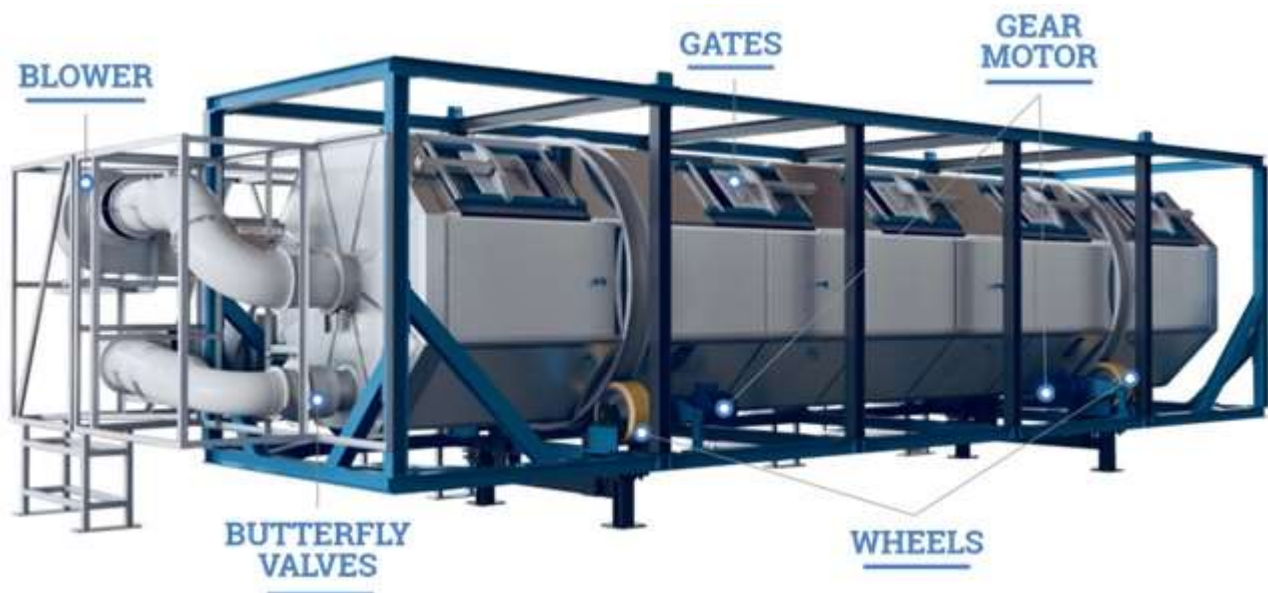
Figura 7: Rappresentazione 3D di un modulo BioDryer™
