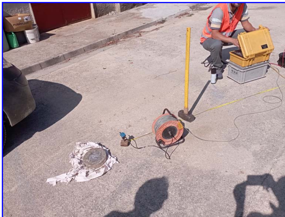
Figura 3 - Sorgente energizzante, costituita da massa battente su piastra di alluminio. Come starter/trigger è stato utilizzato un geofono verticale Geospace a 14Hz.
