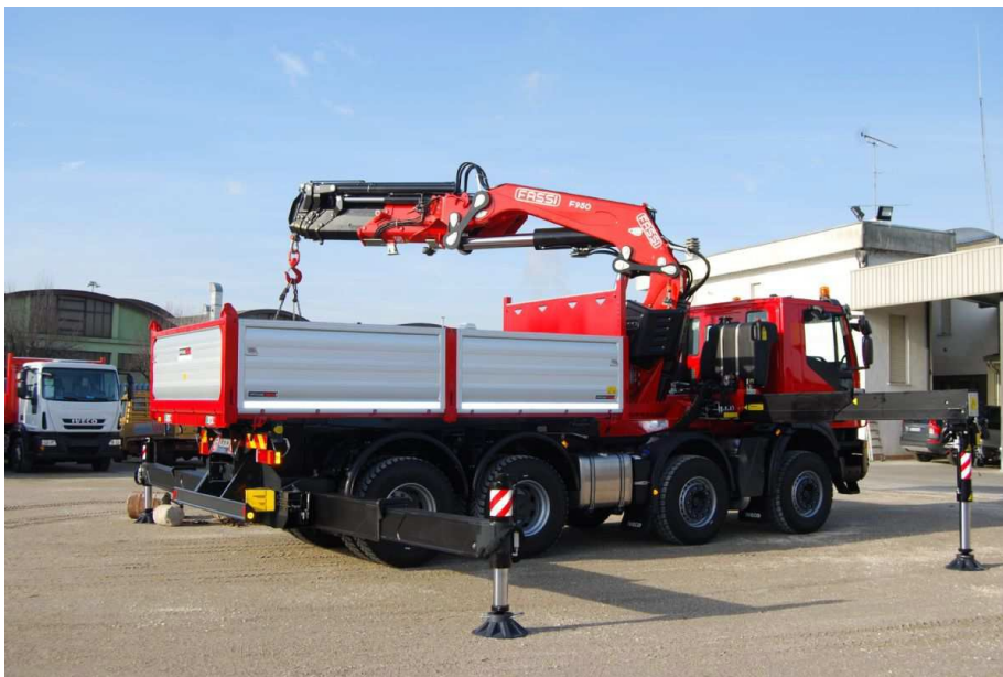
Figura 6: Autocarri con gru per la movimentazione dei carichi
