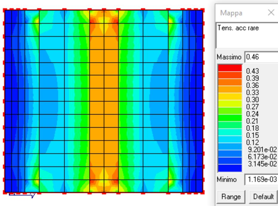
**Figura 24: Verifica tensioni rare nell'acciaio.**
