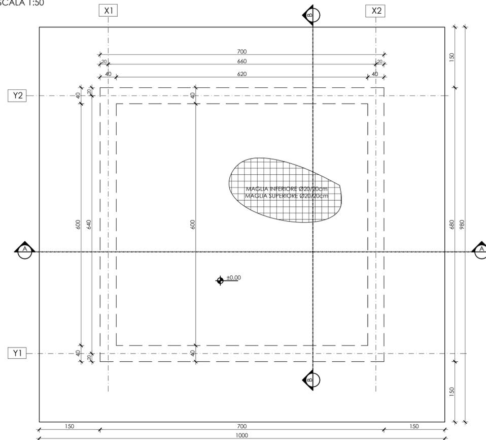
SEZIONE B-B: ARMATURA OPERE IN C.A.
