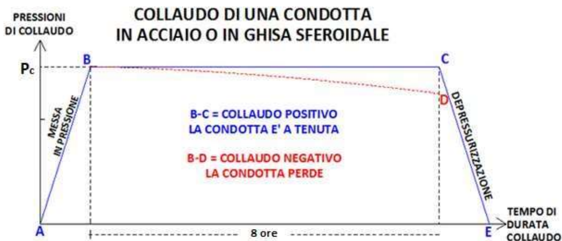
Diagramma tipo delle pressioni per collaudo su ghisa e acciaio
