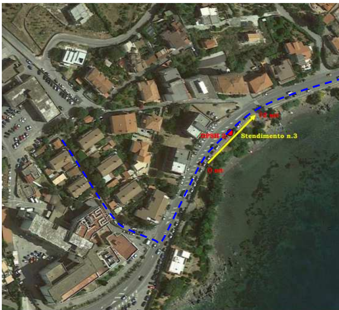
--- Tracciato condotta fognaria di progetto
