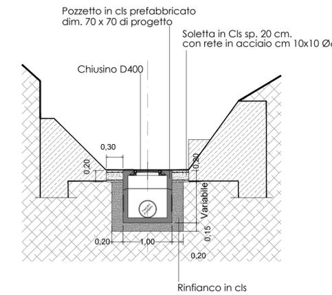
**Sezione Tipo canale, in prossimità di strutture in cls**
