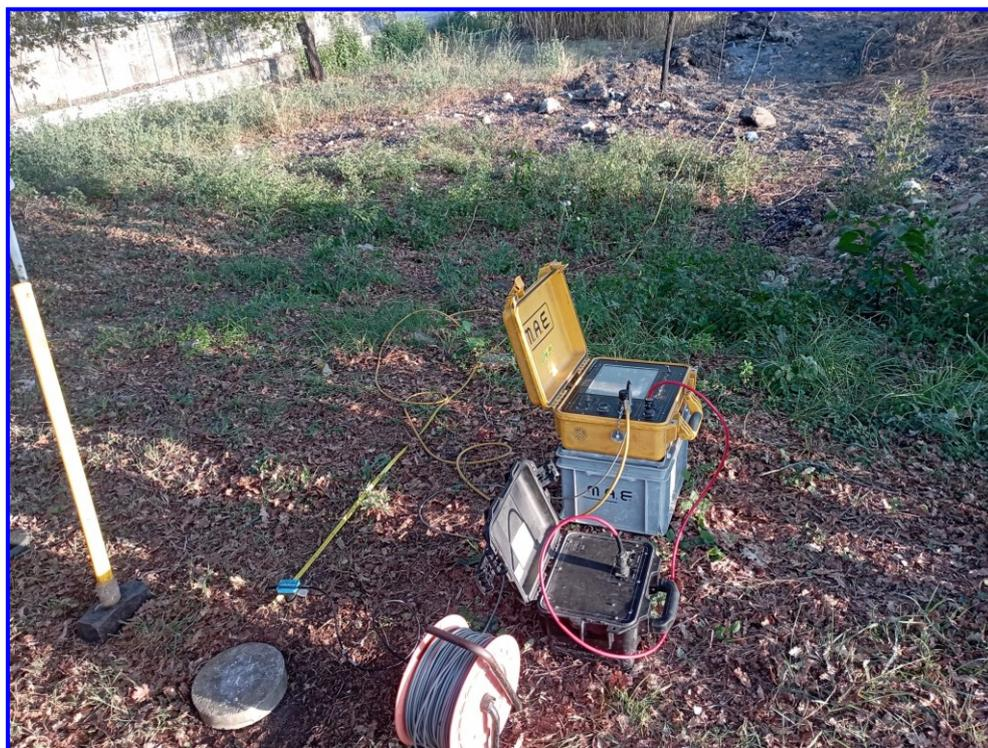
Figura 1 - Prospezione sismica MASW effettuata in area progettuale.
