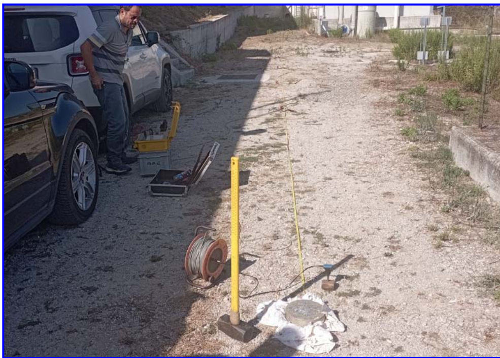
Figura 3 - Sorgente energizzante, costituita da massa battente su piastra di alluminio. Come starter/trigger è stato utilizzato un geofono verticale Geospace a 14Hz.
