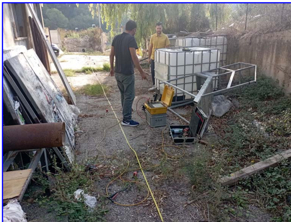
Figura 1 - Prospezione sismica MASW effettuata in area progettuale.
