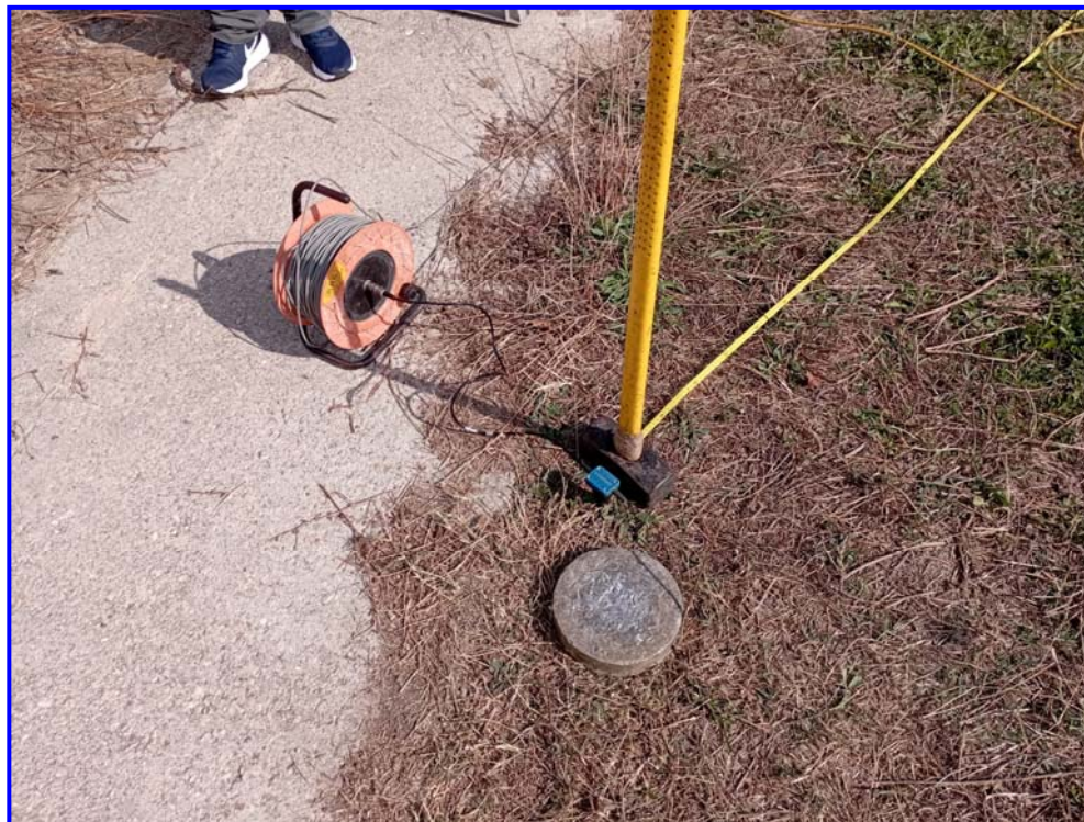
Figura 3 - Sorgente energizzante, costituita da massa battente su piastra di alluminio. Come starter/trigger è stato utilizzato un geofono verticale Geospace a 14Hz.
